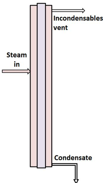
**Figure 4. Rouillard’s venting.**
