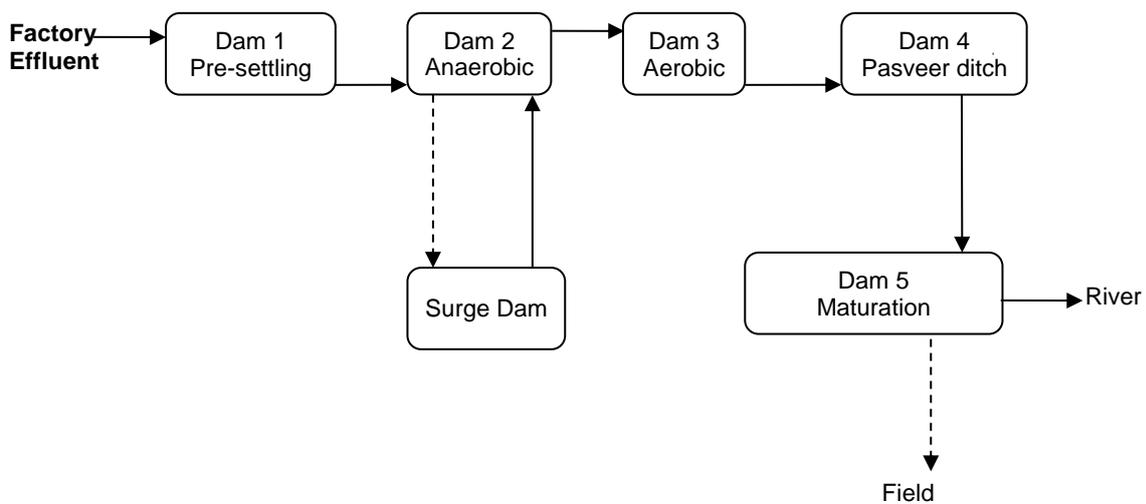
**Figure 9. Current effluent flow arrangement.**
