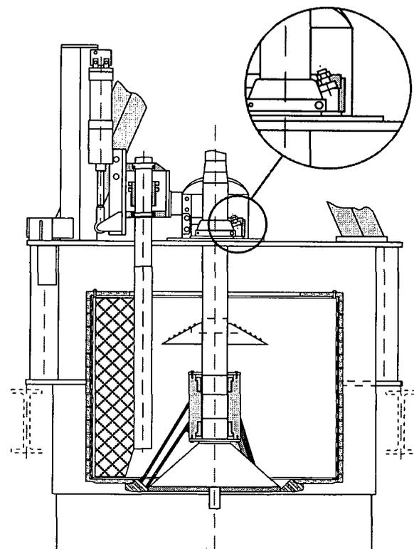
Figure 4. Discharger arrangement.
